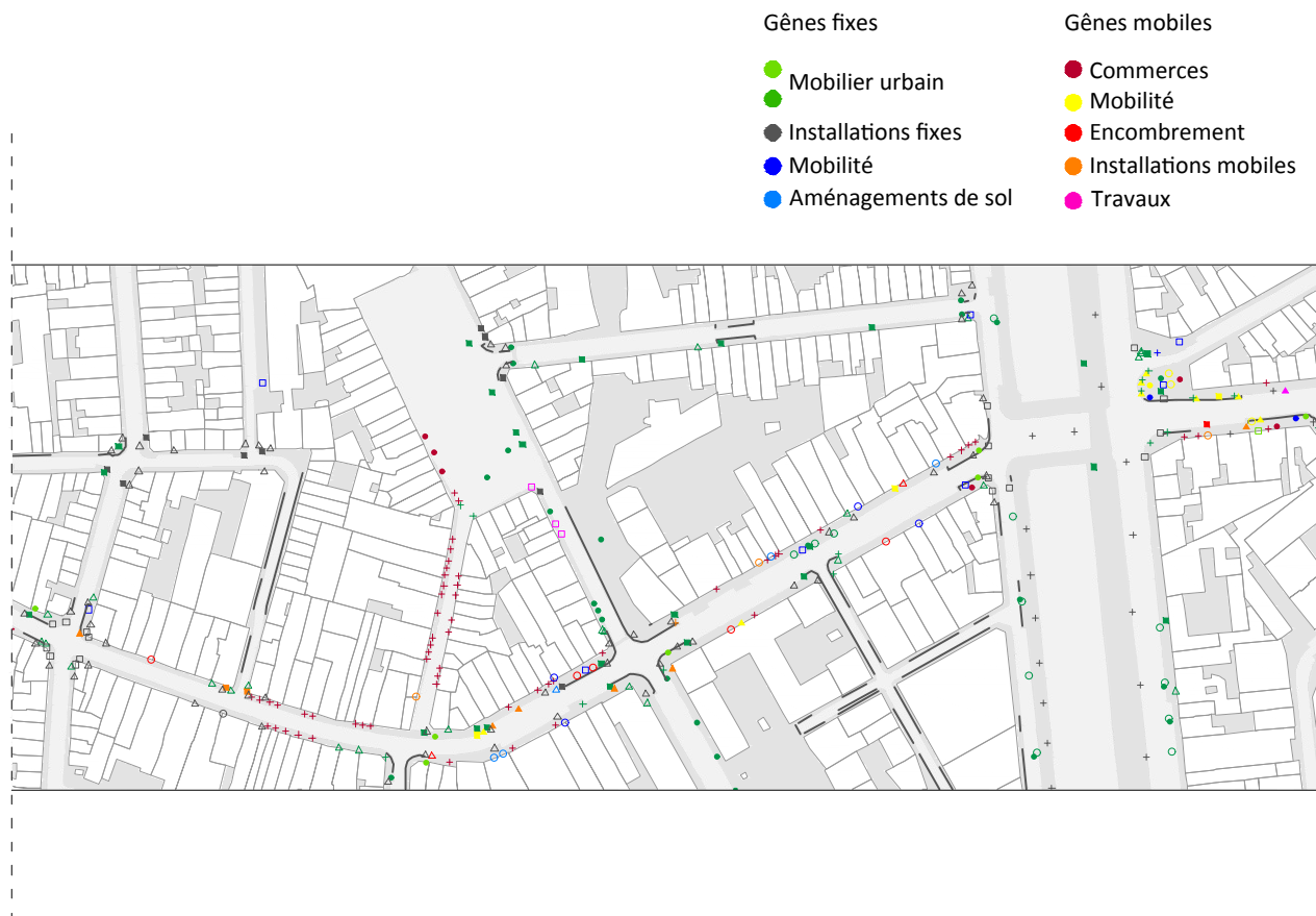
Exemples de gènes relevées sur le tronçon
